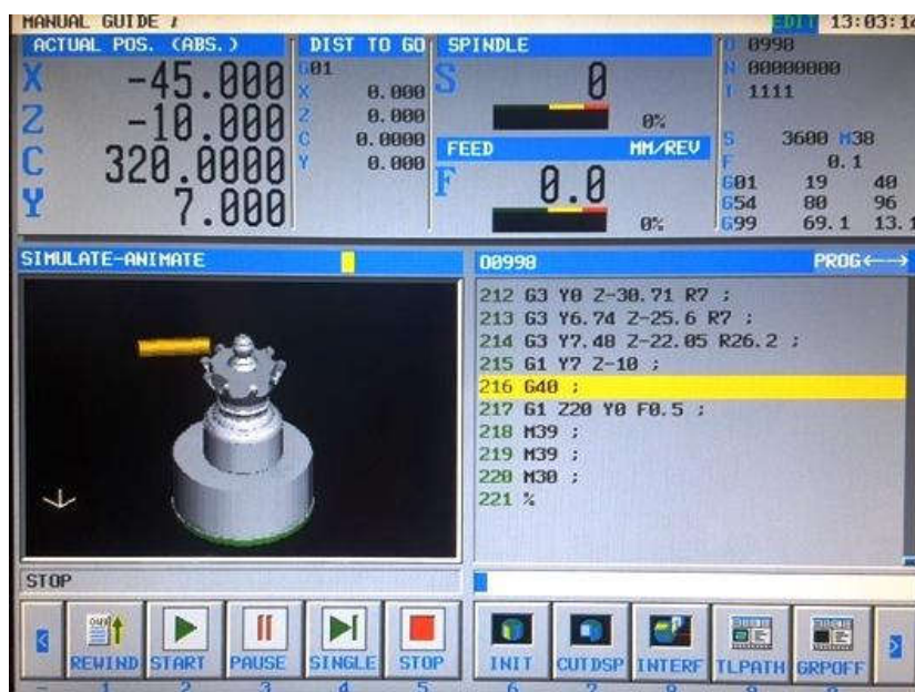
Slika 3.2.22 Grafička simulacija glodanja utora
