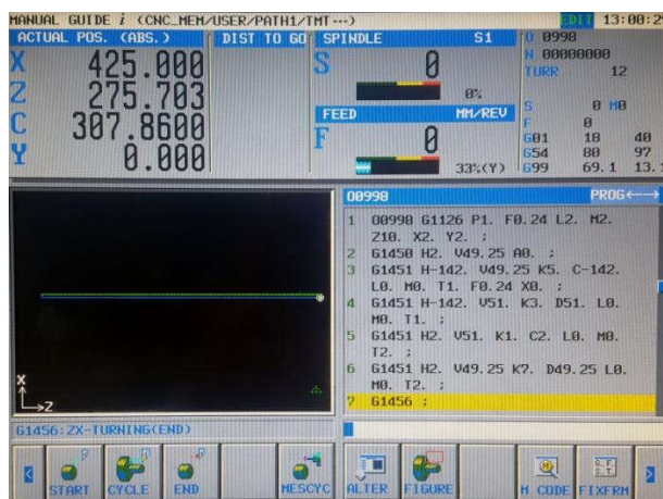
Slika 3.2.13 Ciklus za vanjsko uzdužno fino tokarenje
