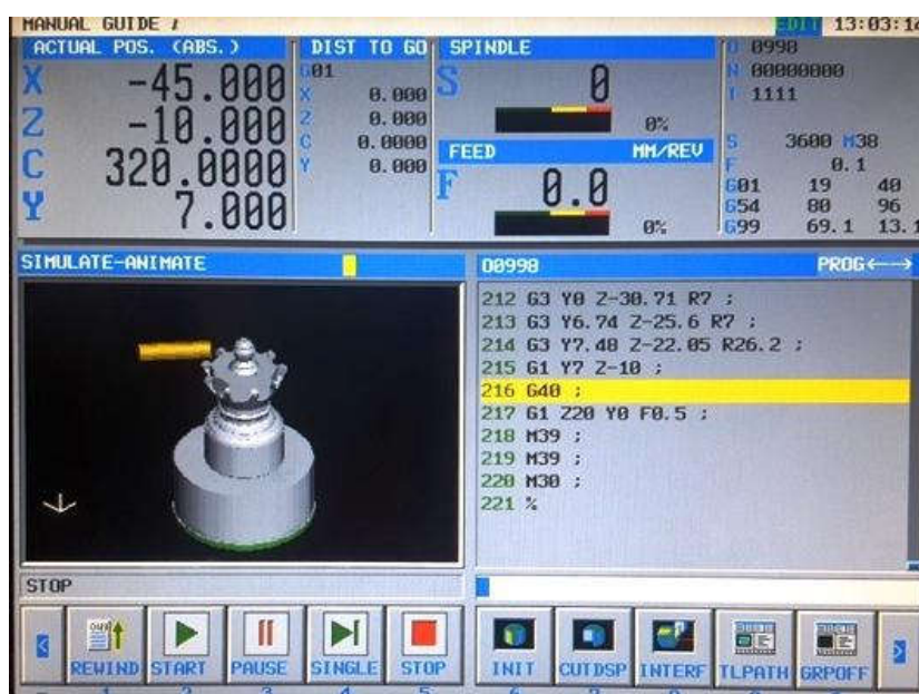
Slika 3.2.22 Grafička simulacija glodanja utora
