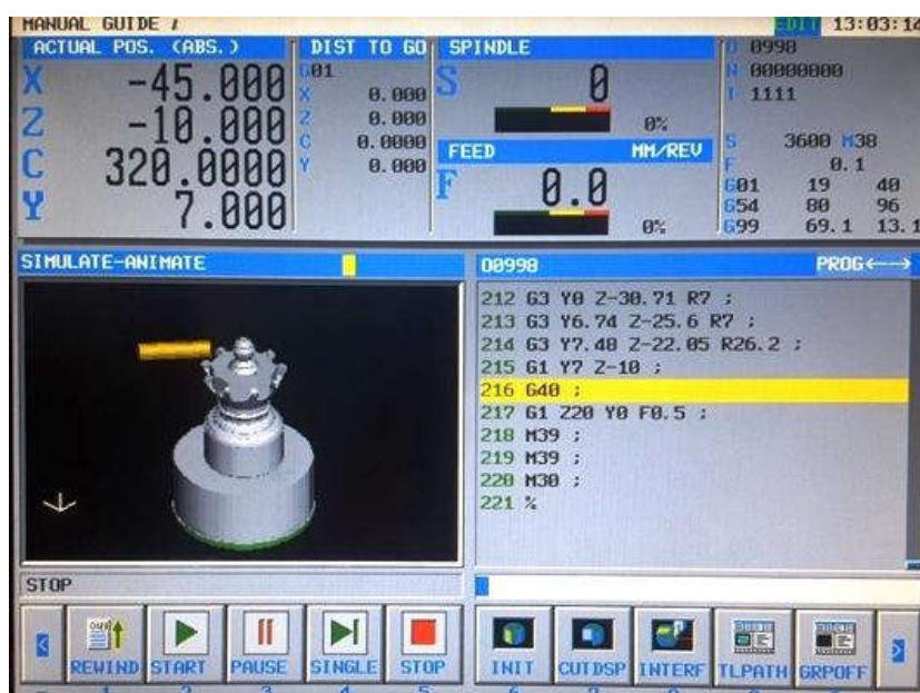
Slika 3.2.22 Grafička simulacija glodanja utora
