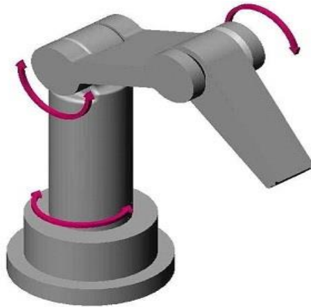
Slika 4. Rotacijska konfiguracija robota
