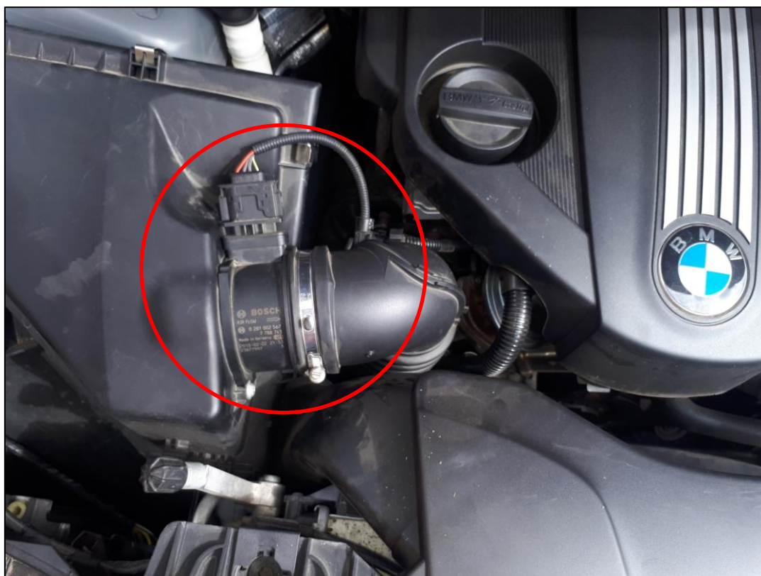
Slika 4.2.1.5. Položaj MAF senzora na vozilu
