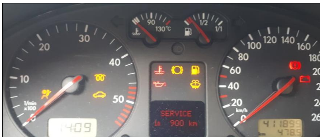
Slika 3.6.2. Lampice na kontrolnoj ploči
