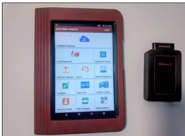
Slika 4.1.2. Tablet sa dijagnostičkim programom i VCI konektor
