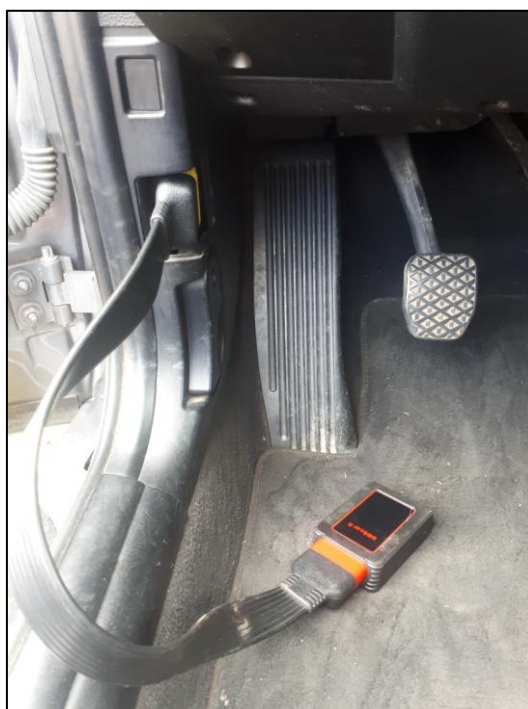
Slika 4.2.1.2. Spajanje VCI konektora na DCL
