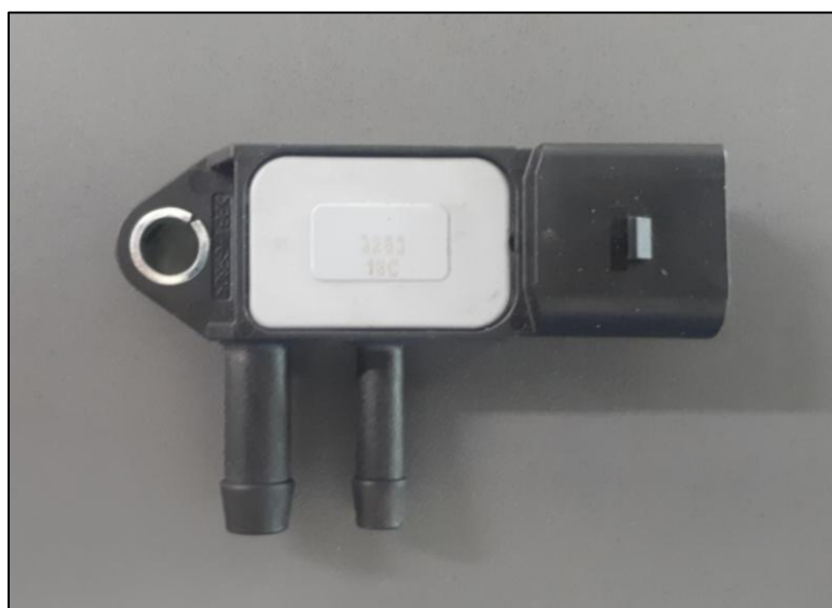
Slika 4.2.3.2. Senzor diferencijalnog tlaka
