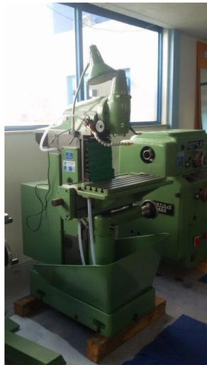
Slika 7.2 klasična glodalica
