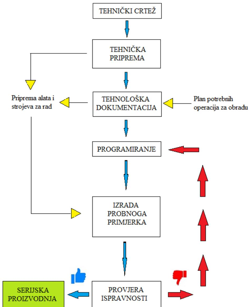
Slika 1.2-1 Shematski prikaz procesa od tehničkog crteža do serijske proizvodnje
