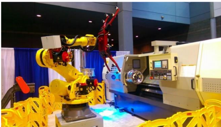
Slika 3.2.1.1. Izmjena obradka uz pomoć robota[10]
