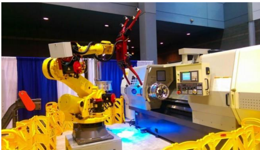
Slika 3.2.1.1. Izmjena obradka uz pomoć robota[10]
