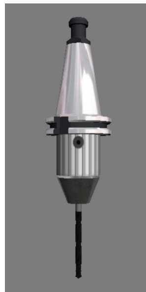
Slika 3.5 Spiralni alat za bušenje 8,5 mm
