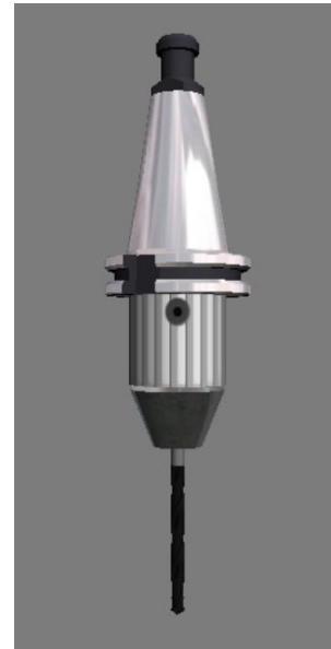
Slika 3.5 Spiralni alat za bušenje 8,5 mm
