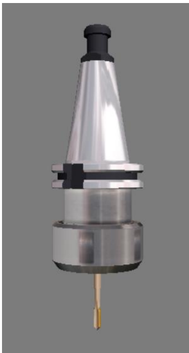
Slika 3.6 Alata za bušenje navoja M10
