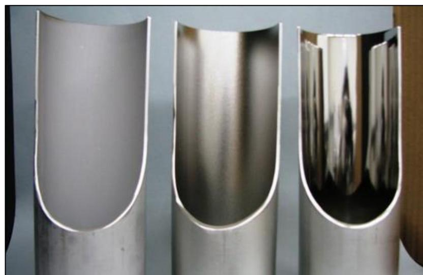
Slika 48: Izgled unutrašnjosti cijevi od nehrđajućeg čelika u izvornom stanju (lijevo), nakon mehaničke obrade (sredina) i nakon elektropoliranja (desno) [52]
