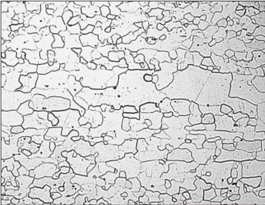
Slika 23: Mikrostruktura feritnih nehrđajućih čelika [22]
