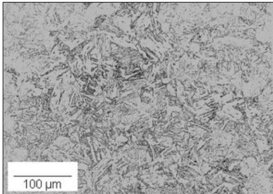
Slika 30: Mikrostruktura martenzitnih nehrđajućih čelika [26]
