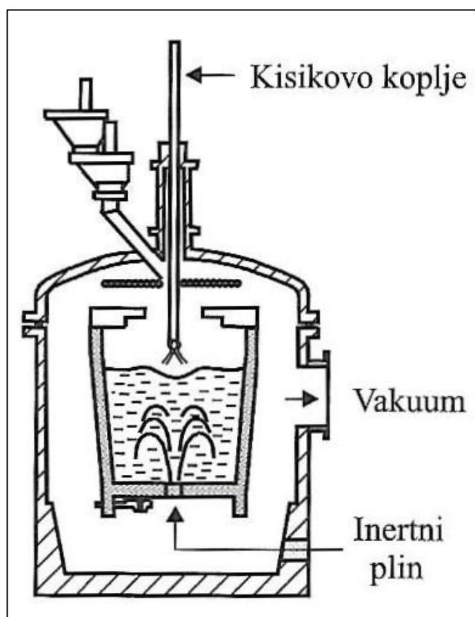
Slika 8: Shematski prikaz VOD procesa [1]
