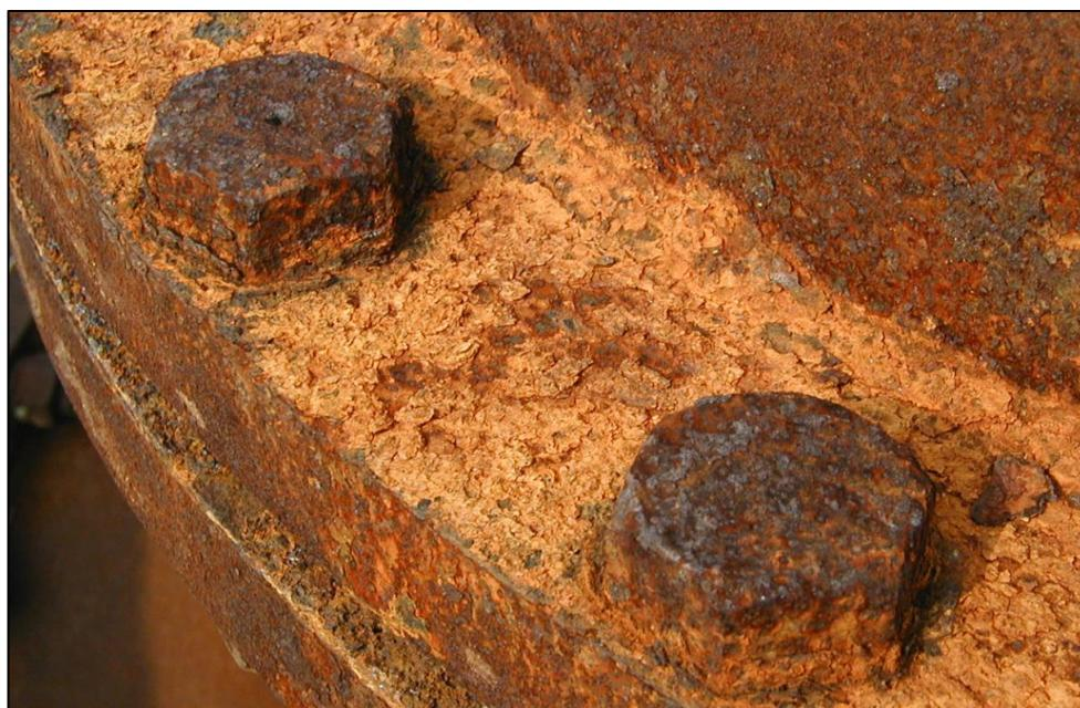
Slika 12: Opća korozija [17]
