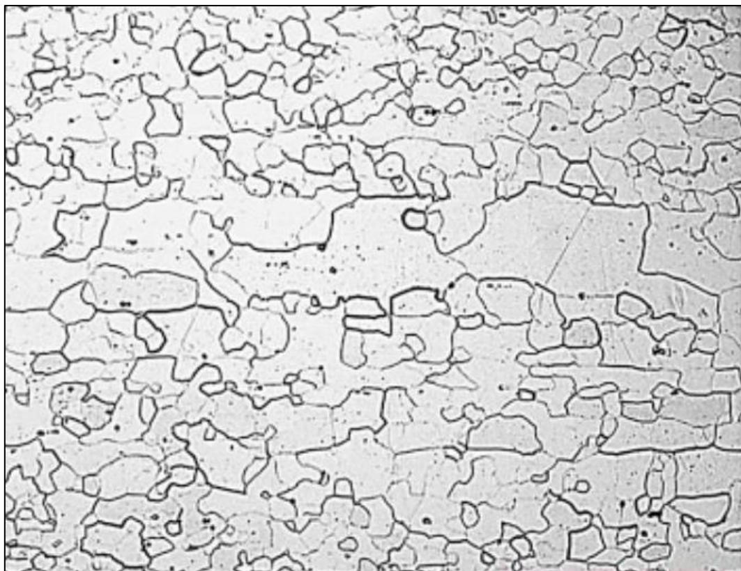
Slika 23: Mikrostruktura feritnih nehrđajućih čelika [22]
