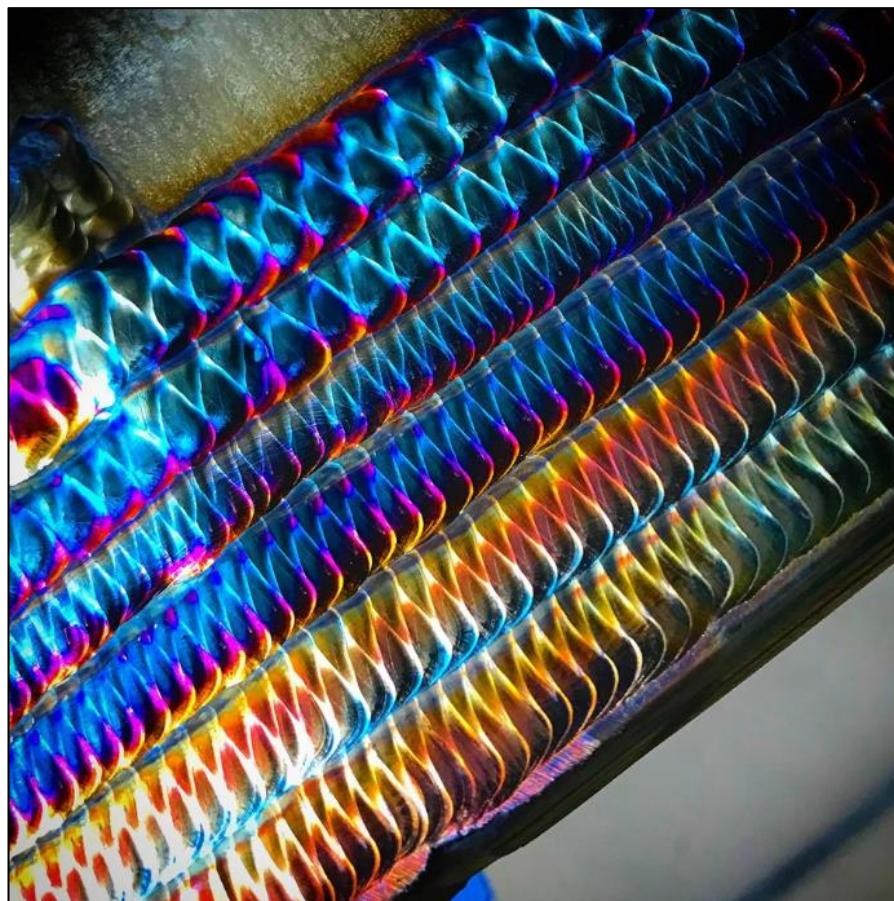
Slika 33: Obojenost nehrđajućeg čelika nakon zavarivanja [32]
