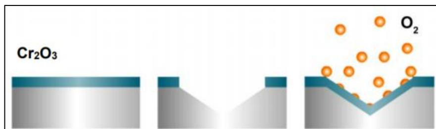
Slika 9: Mehanizam samoobnavljanja pasivnog sloja kromovih oskida [11]
