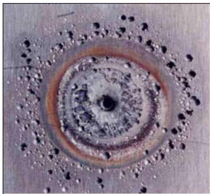
Slika 13: Točkasta korozija [20]
