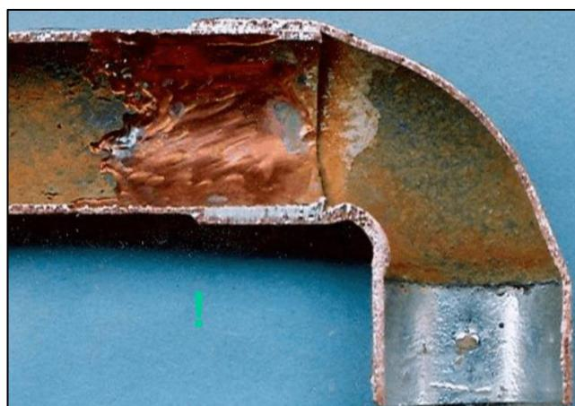
Slika 21: Erozijska korozija [20]
