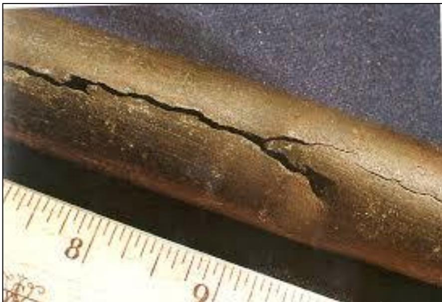
Slika 18: Napetosna korozija [7]
