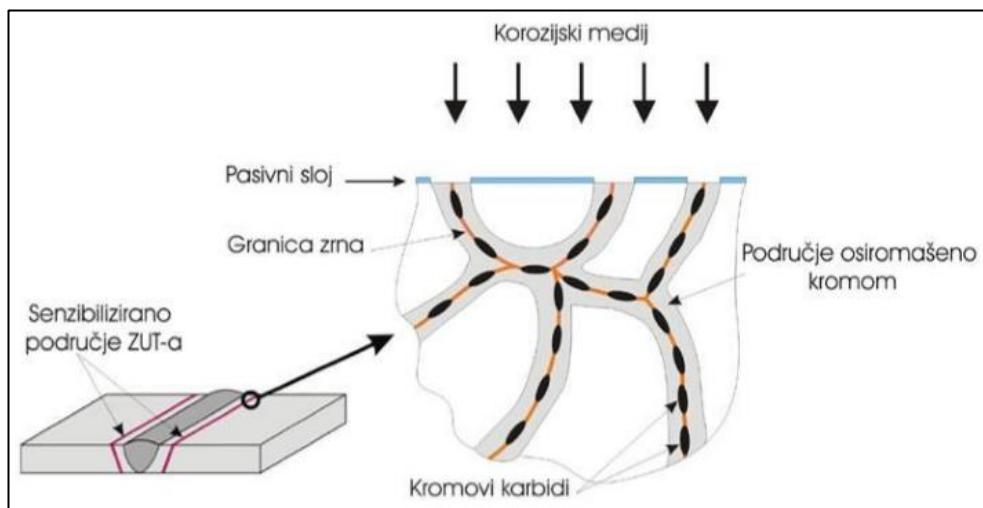
Slika 14: Mehanizam nastanka interkristalne korozije [13]
