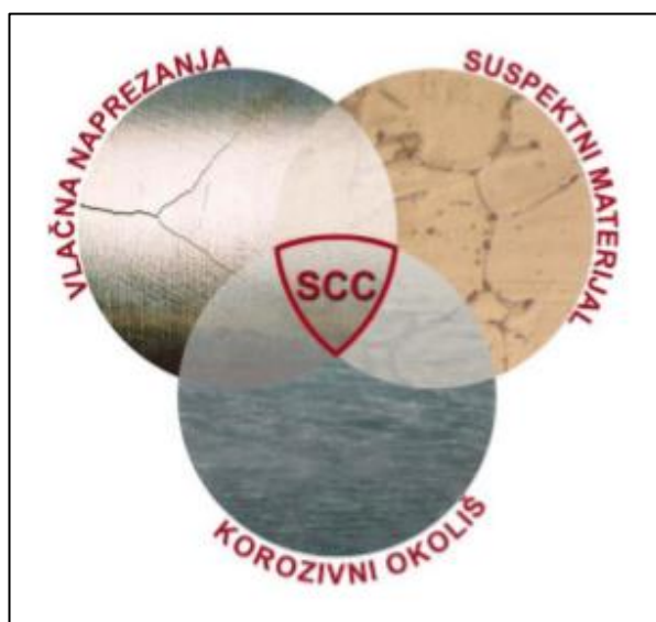
Slika 16: Utjecajni čimbenici napetosne korozije [13]
