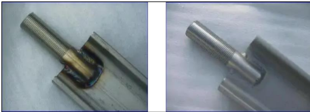
Slika 46: Izgled zavara prije (lijevo) i poslije (desno) nagrivanja [46]
