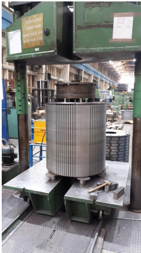
Slika 3.3 Paket spreman za prešanje
