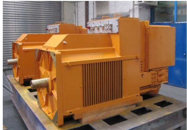
Slika 5.2 Specijalni motor za bušenje
