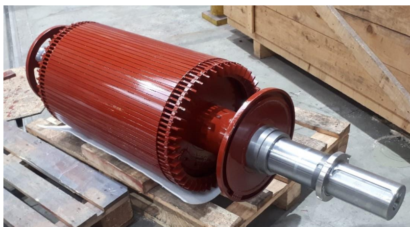
Slika 3.23 Zaštićen rotor sa vratilom
