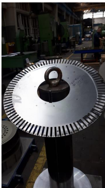
Slika 3.2 Ulaganje krajnjeg lima na napravo za pakiranje
