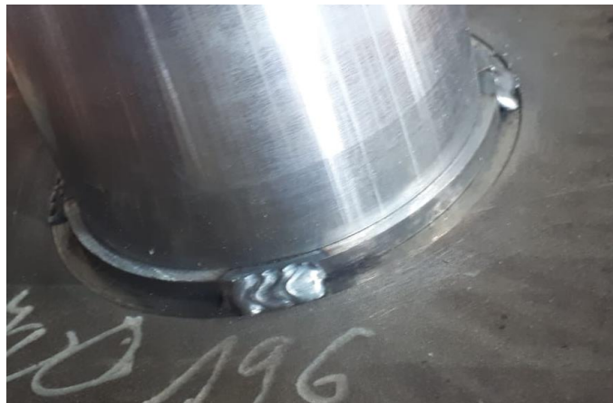
Slika 3.9 Zavarivanje poluprstena (osiguranje)
