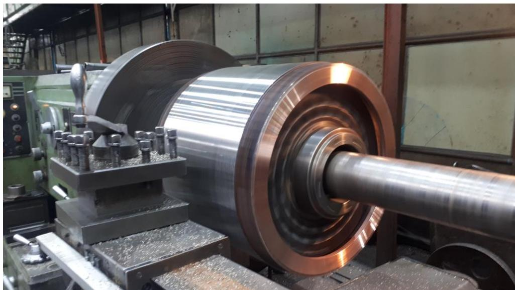
Slika 3.19 Tokarenje rotora
