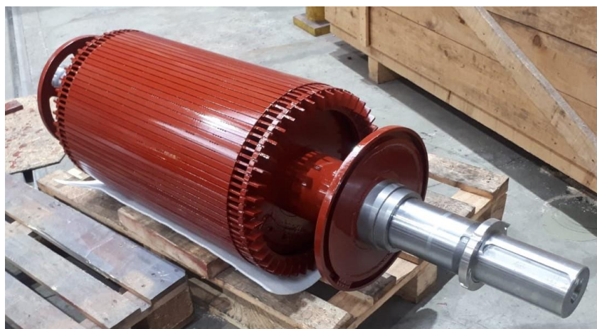
Slika 3.23 Zaštićen rotor sa vratilom
