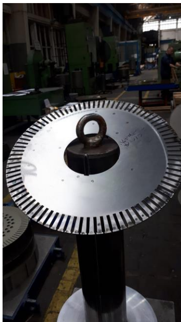
Slika 3.2 Ulaganje krajnjeg lima na napravo za pakiranje
