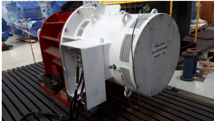
Slika 4.3 Zatvaranje kućišta i spajanje motora na mrežu
