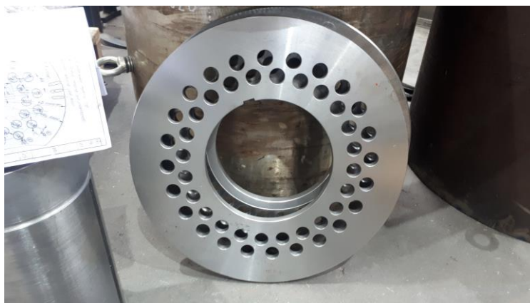
Slika 2.13 Tlačna ploča sa provrtima za hlađenje paketa
