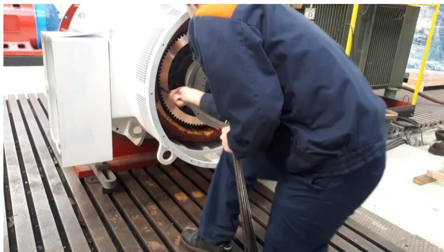
*Slika 4.2 Ispitivanje zračnog raspora limovima*
