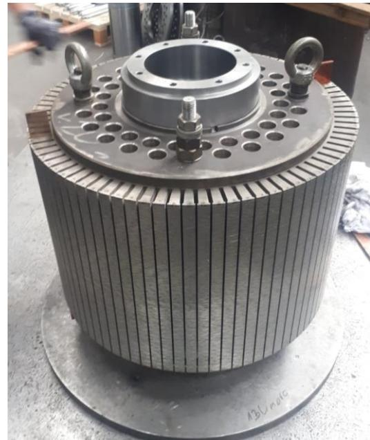
Slika 3.7 Paket spremam za naprešavanje
