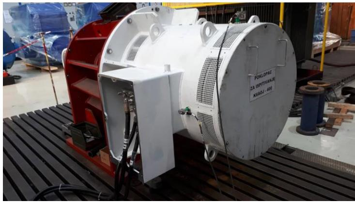
Slika 4.3 Zatvaranje kućišta i spajanje motora na mrežu
