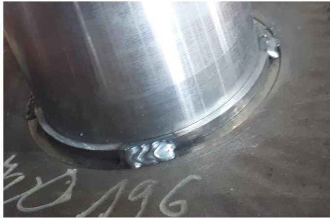
Slika 3.9 Zavarivanje poluprstena (osiguranje)
