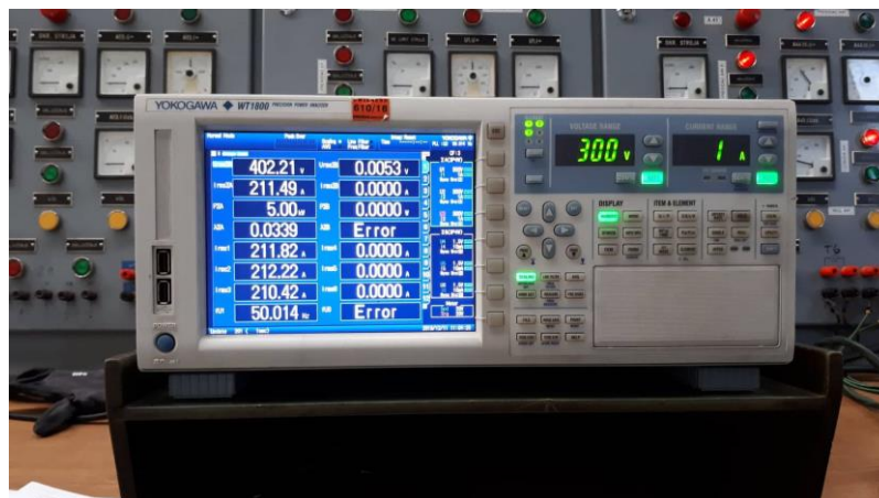
Slika 4.5 Rezultati ispitivanja na analizatoru snage „YOKOGAWA WT1800“
