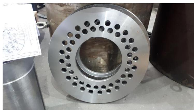
*Slika 2.13 Tlačna ploča sa provrtima za hlađenje paketa*
