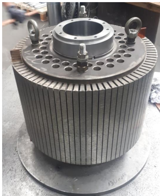
Slika 3.7 Paket spreman za naprešavanje
