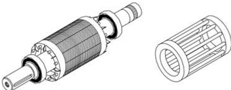
Slika 2.1 Kavezni rotor asinkronog motora
