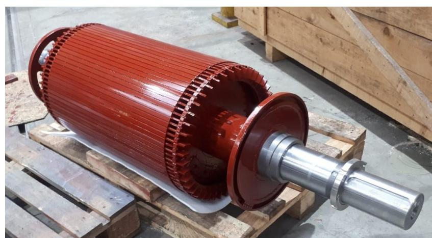
*Slika 3.23 Zaštićen rotor sa vratilom*
