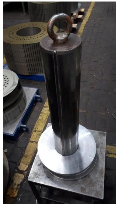
*Slika 3.1 Naprava za paketiranje sa postavljenom tlačnom pločom*
