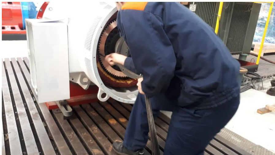
Slika 4.2 Ispitivanje zračnog raspora limovima
