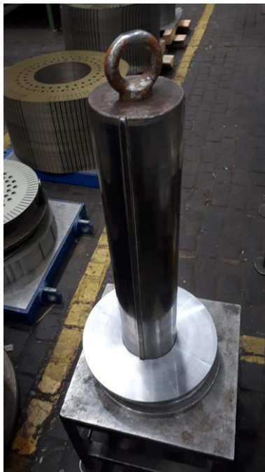
Slika 3.1 Naprava za pakiranje sa postavljenom tlačnom pločom
