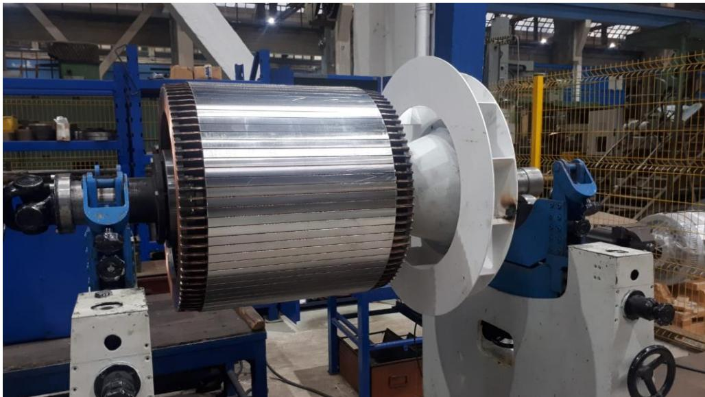
*Slika 3.21 Balansiranje rotora*
