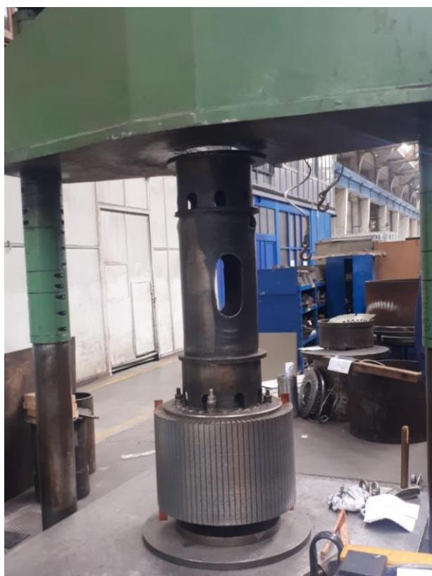
Slika 3.8 Naprešavanje glavine rotora u paket
