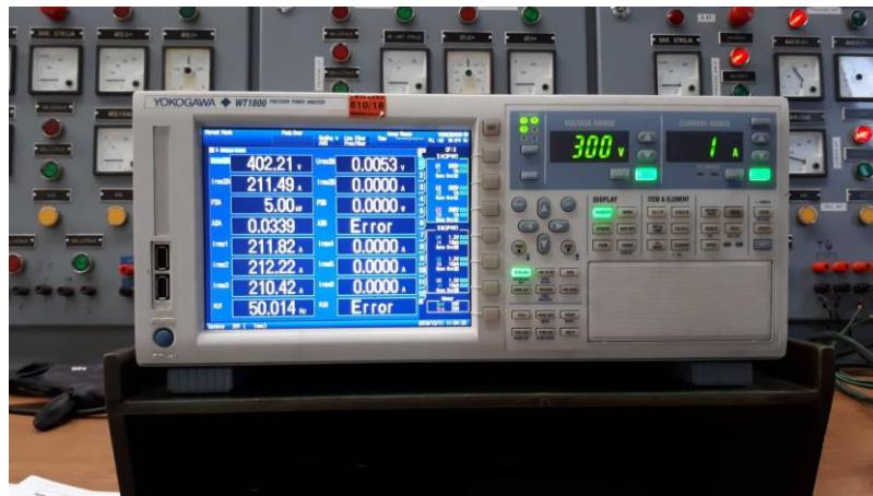
Slika 4.5 Rezultati ispitivanja na analizatoru snage „YOKOGAWA WT1800“
