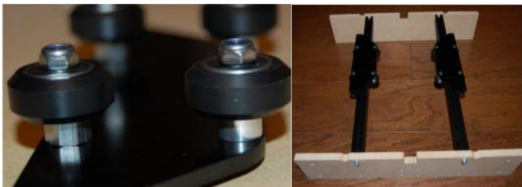
Slika 2.13 Klizač Y osne vodilice (lijevo); Y osne vodilice s klizačem (desno) [26]
