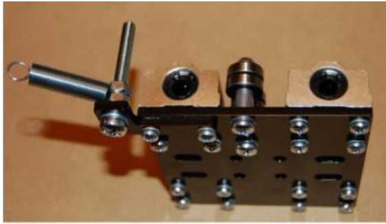
Slika 2.15 Z osni sklop ležajne ploče [26]
