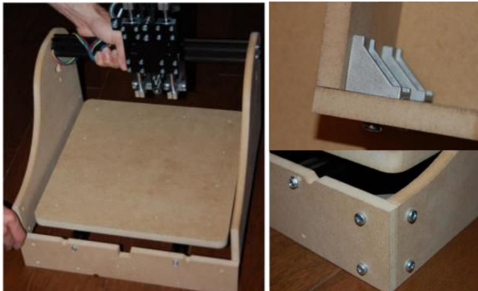
Slika 2.17 X i Z osni podsklop povezan s Y osnim (lijev); Učvršćenje kutova okvira (desno) [26]
