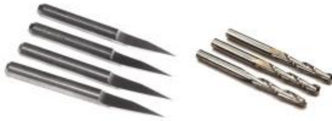
Slika 3.5 Odabrani alat za obradu: lijevo – V glodalo [30]; desno – glodalo s ravnim krajem [31]
