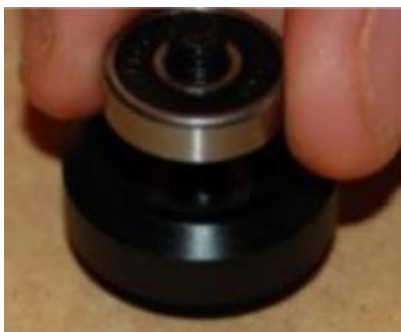
Slika 2.12 posklop kompleta V kotačića [26]
