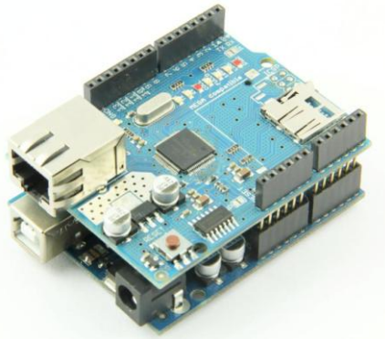
Slika 5-1. Ethernet Shield spojen na Arduino
