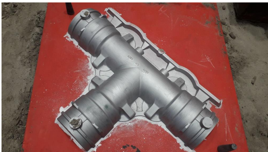
Slika 6.1: Gornjak premazan premazom za zaštitu od abrazije
