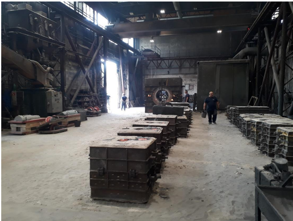
Slika 6.9: Odlijani kalupi u hali za ručno kalupljenje
