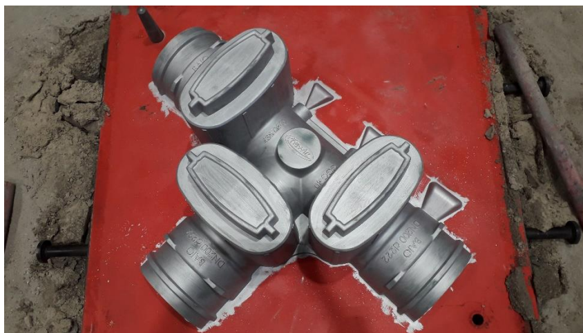
Slika 6.4: Donjak premazan premazom za zaštitu od abrazije
