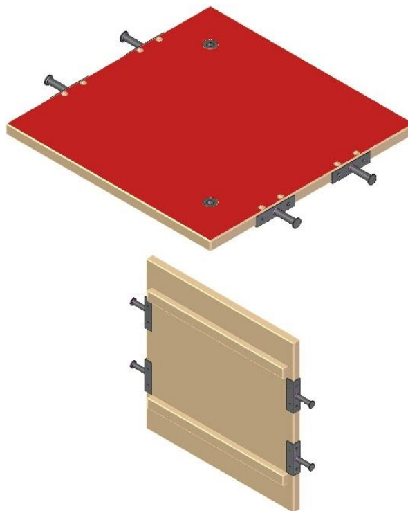
Slika 3.11 Modelna ploča za smještaj modela
