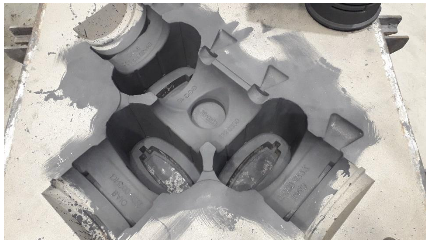
Slika 6.5: Forma donjaka zaštićena vatrootpornim premazom radi zaštite od taline
