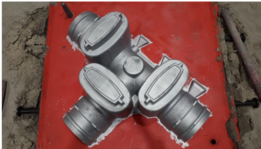
Slika 6.4: Donjak premazan premazom za zaštitu od abrazije
