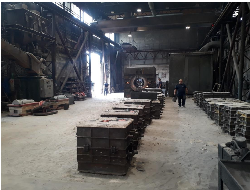
Slika 6.9: Odlijani kalupi u hali za ručno kalupljenje
