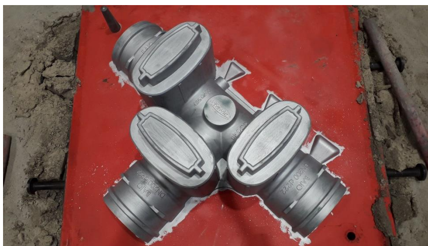
Slika 6.4: Donjak premazan premazom za zaštitu od abrazije
