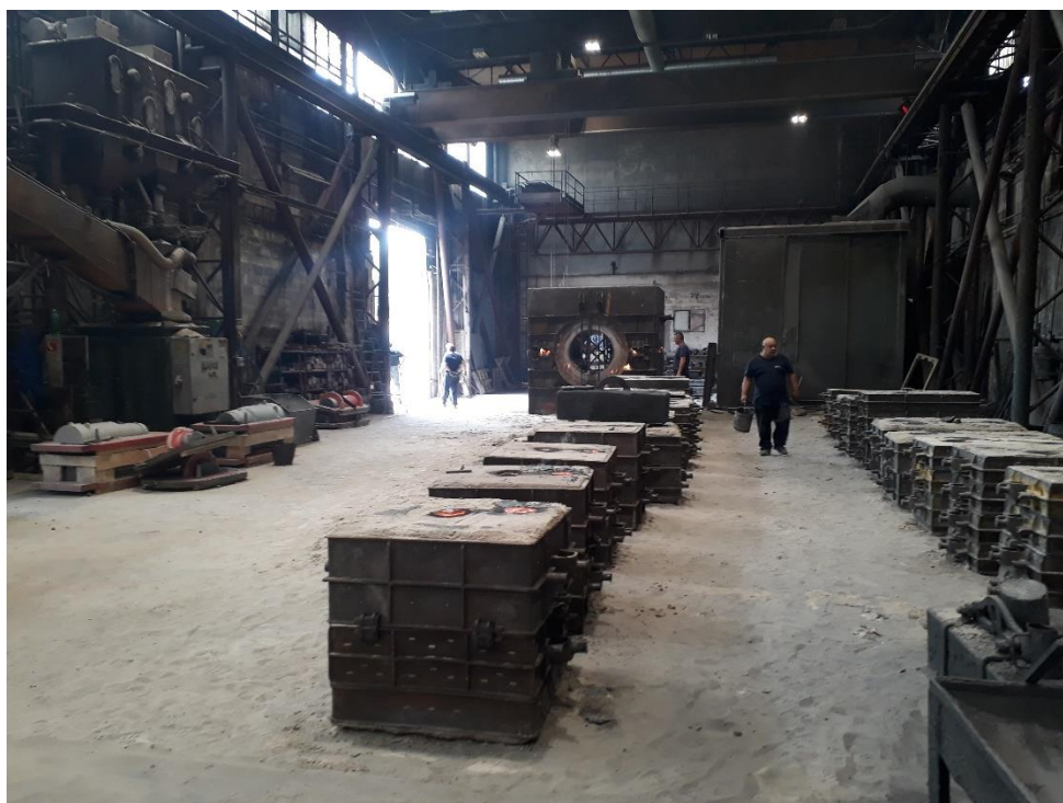
Slika 6.9: Odlijani kalupi u hali za ručno kalupljenje
