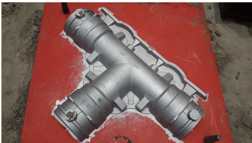
Slika 6.1: Gornjak premazan premazom za zaštitu od abrazije
