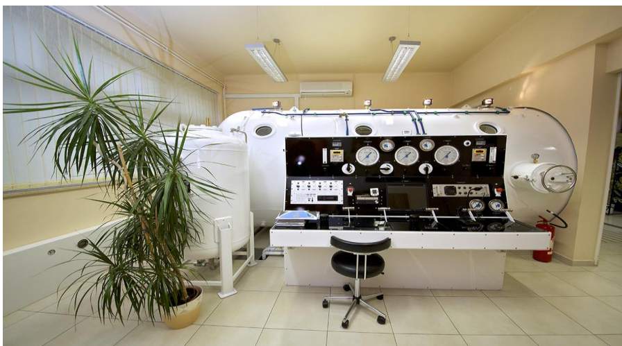
Slika 3.2.1. Višemjesna HB komore s kontrolnom pločom Izvor: http://oxy.hr/fotogalerija/lijecenje/galerija-poliklinike-oxy
