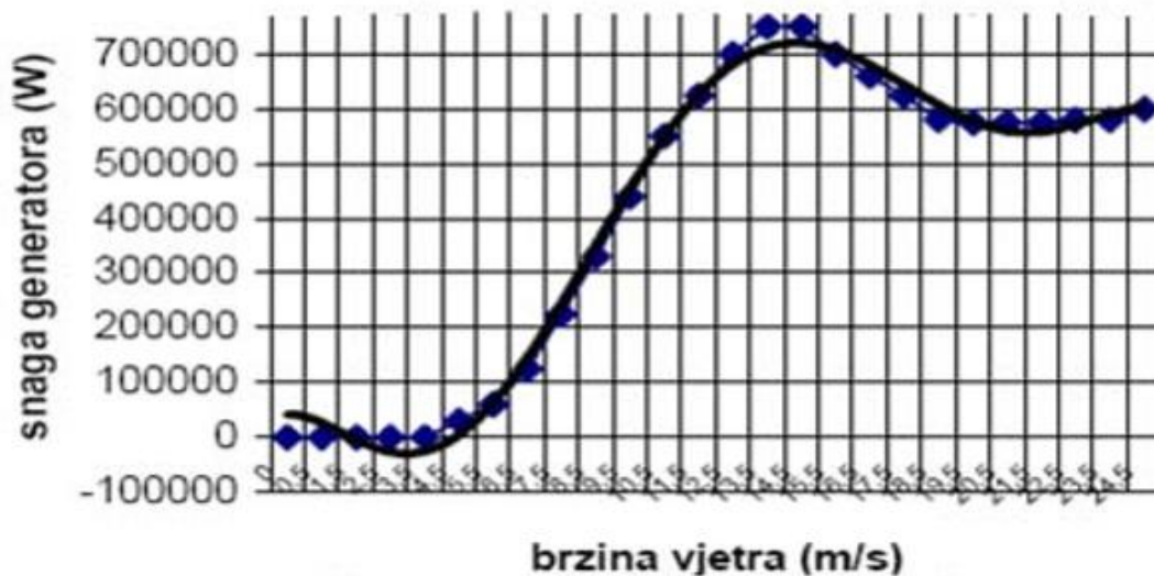
Slika 3.2. Ovisnost snage vjetrogeneratora o brzini vjetra [10]
