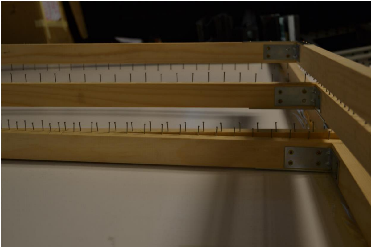
Slika 5.29. Gotove daske sa čavlima spremne za sprejanje
