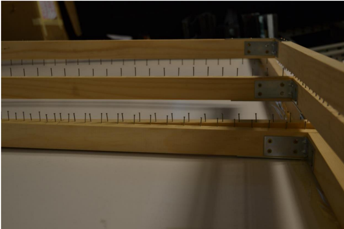
Slika 5.29. Gotove daske sa čavlima spremne za sprejanje
