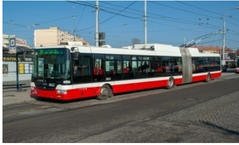
Slika 25. Zglobni troosovinski trolejbus
