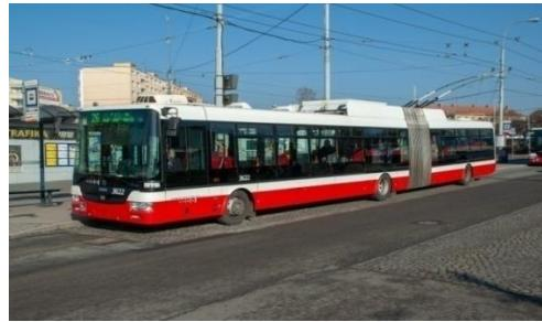
Slika 25. Zglobni troosovinski trolejbus
