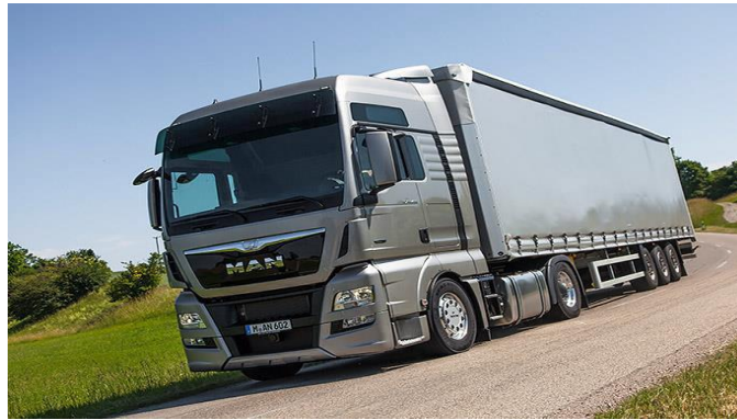
Slika 7. Tegljač s poluprikolicom
