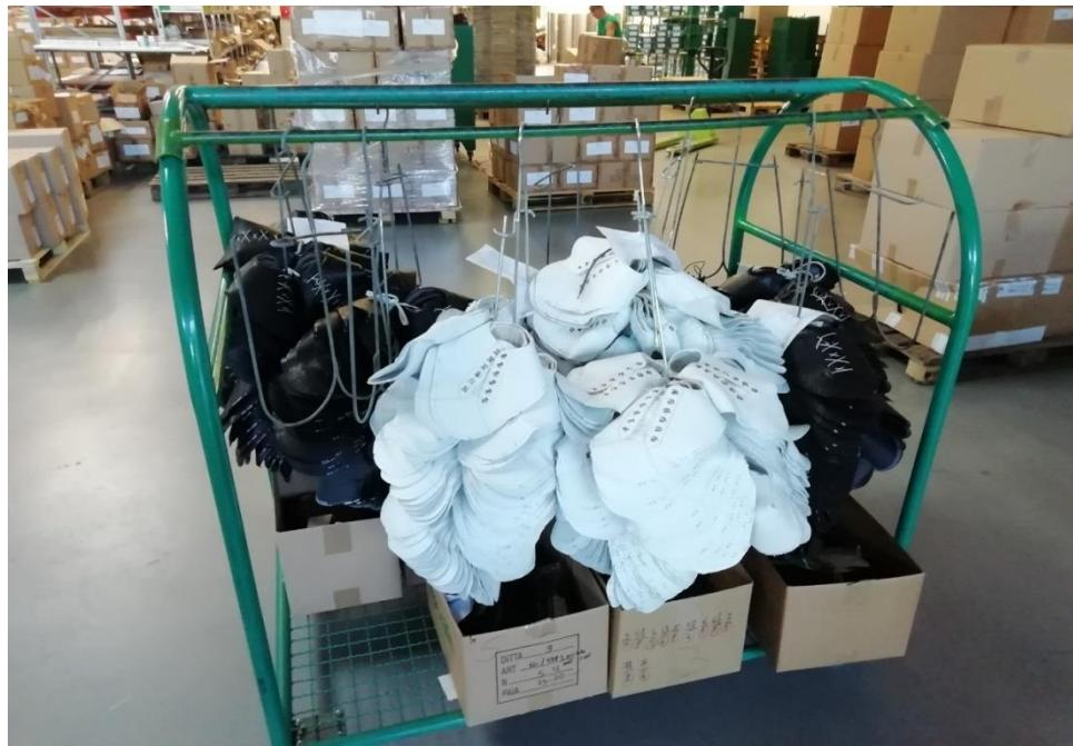
*Slika 42: Ručna kolica za prijevoz gornjih dijelova obuće*
