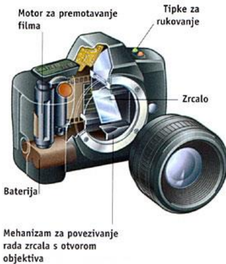
Slika 8: Prikaz SLR fotoaparata
