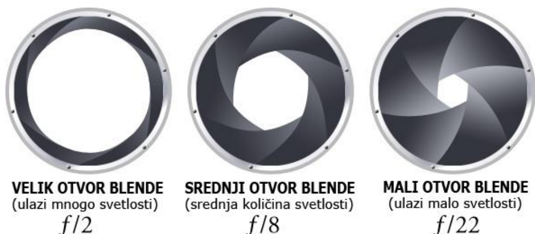
Slika 10: Prikaz manipulacije otvora blende
