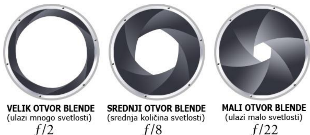
Slika 10: Prikaz manipulacije otvora blende
