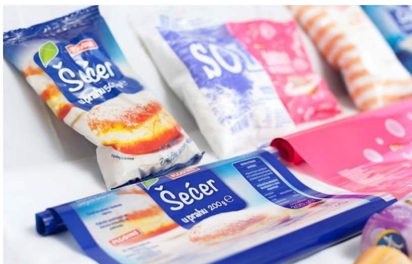
Slika 28. Primjer duplex folije
