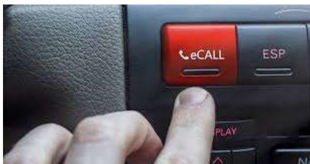
Slika 11. Tipka ePoziv (eCall) u vozilu
