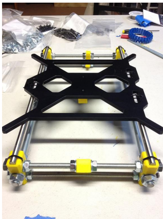
Slika 32. Y os Pruse i3 MK3- tiskani dijelovi prikazani su žutom bojom
