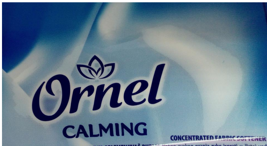
Slika 56. Nedostatak rastera u finim dijelovima
