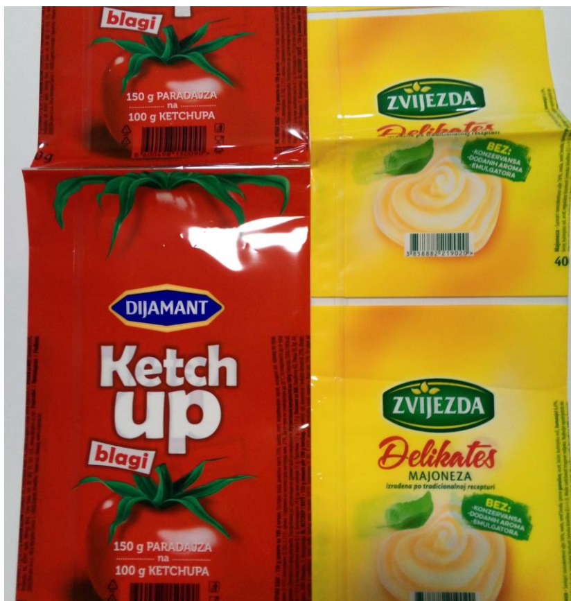
Slika 51. Transparentna etiketa sa standardnom bijelom podlogom
