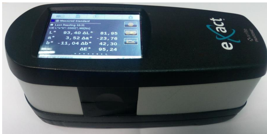
Slika 58. Spektrofotometar „Xrite exact pantone“
