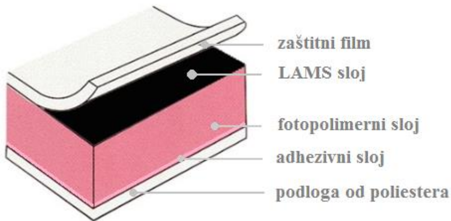
Slika 9. Presjek tiskovne forme s LAMS slojem [13]
