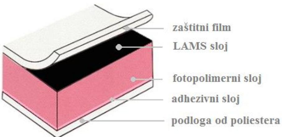
Slika 9. Presjek tiskovne forme s LAMS slojem [13]
