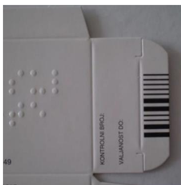
Slika 39. Linijski kod za zatvaranje
