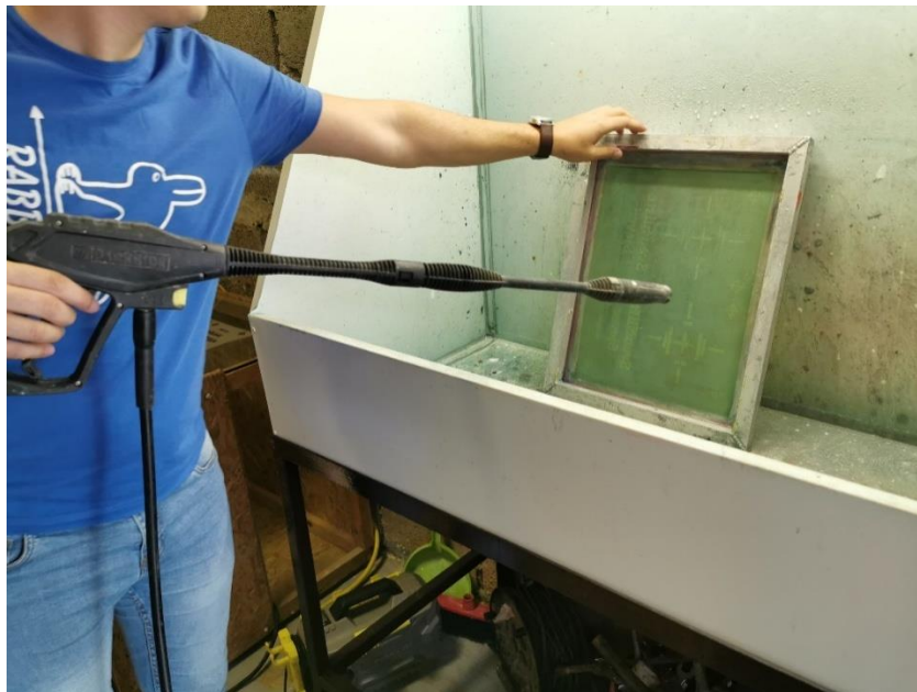
Slika 15: Ispiranje šablone mlazom vode
