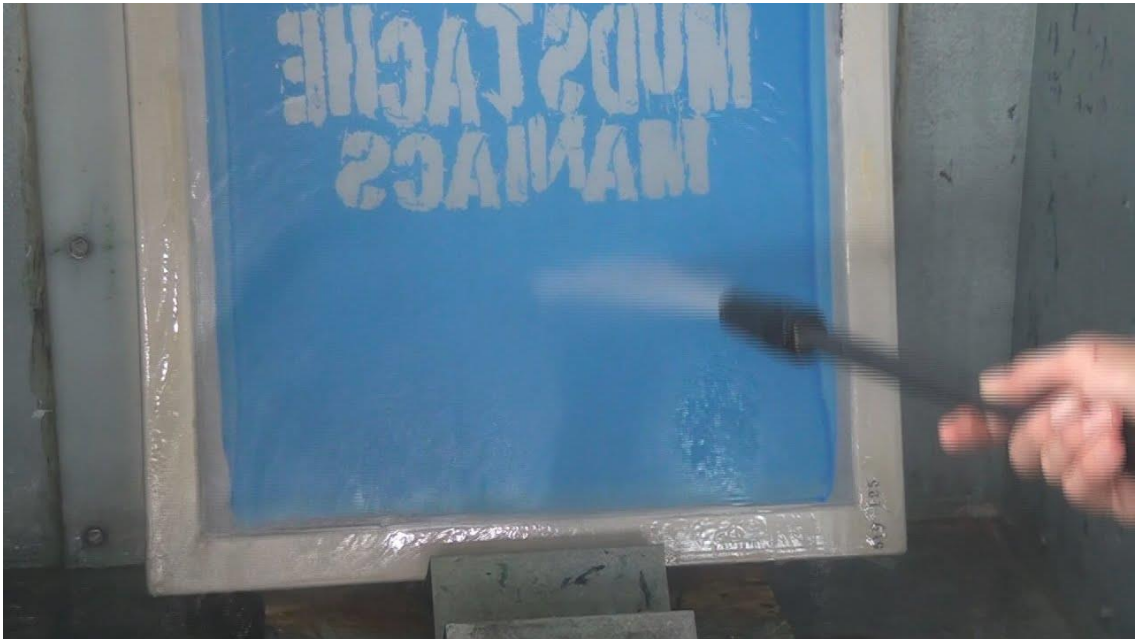
Slika 7: Prikaz ispiranja sita mlazom vode nakon snimanja
