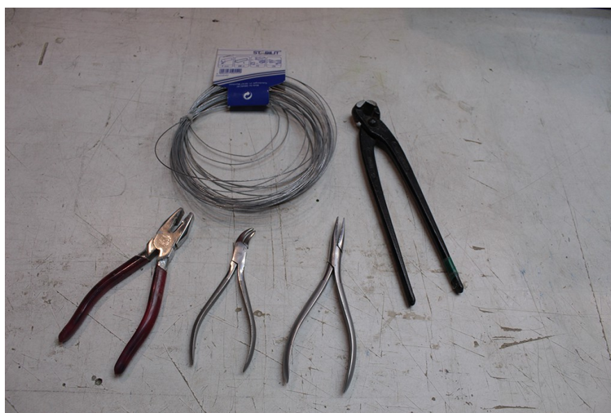
Slika 7.10. Alat za savijanje i obradu žice
