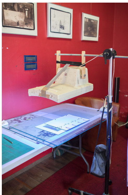
Slika 5.11 Proba test trakica za određivanje intervala osvjetljavanja
