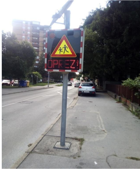
Slika 14. Promjenjiva prometna signalizacija opremljena sensorima
