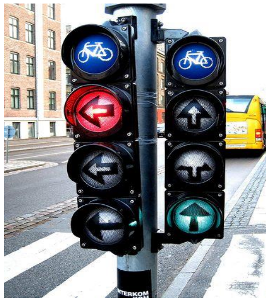
Slika 7. Semafori koji daju prioritet prolaska biciklima
