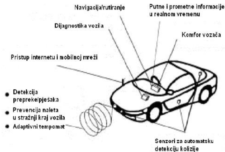
Slika 3. Oprema inteligentnog osobnog vozila
