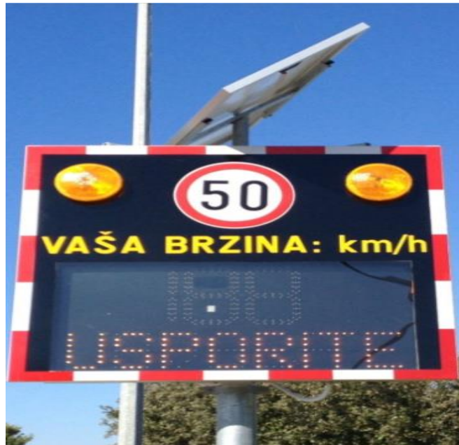
Slika 2. Primjer promjenjive prometne signalizacije
