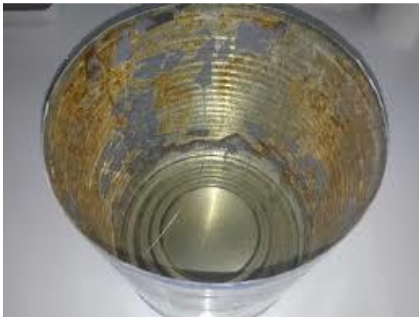
Slika 14. Korozija na unutrašnjoj strani limenke.
