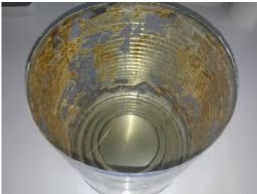
Slika 14. Korozija na unutrašnjoj strani limenke.
