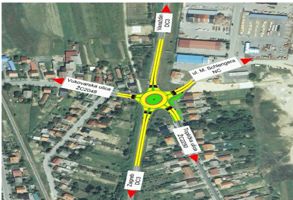
Slika 5.3. Idejno rješenje izgradnje kružnog toka na raskrižju DC 3, ŽC 2250, ŽC 2048 i NC 082
