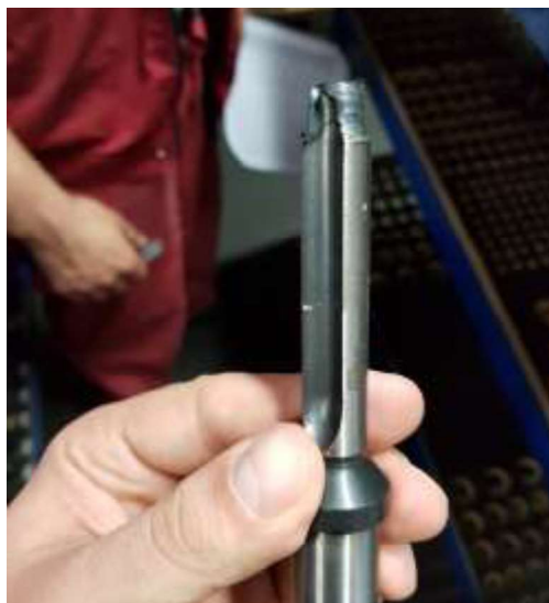
Slika 3.7 Lom AMEC svrdla
