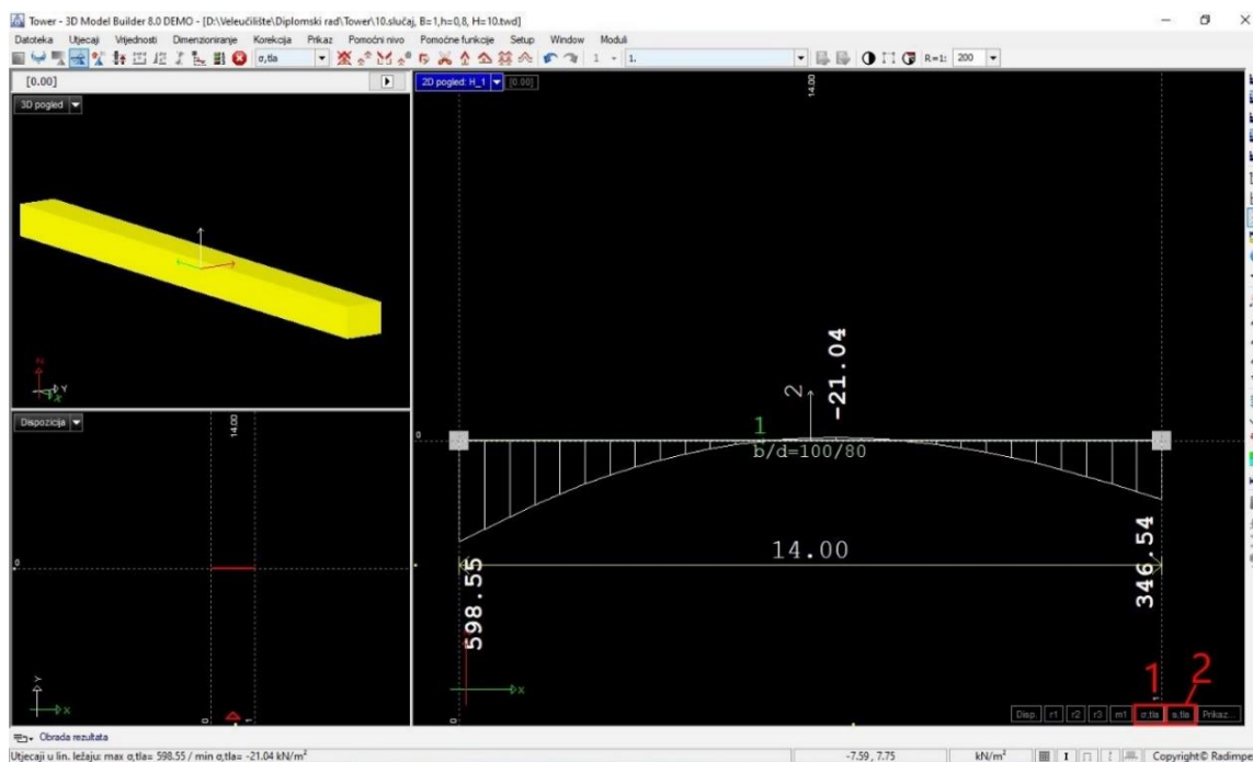
Slika 7.12. Rezultati proračuna, naprezanja u tlu
