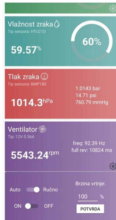
Slika 5.4: Mobilna aplikacija, ručni način - ventilator na 100% brzine
