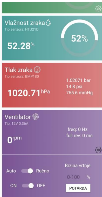
Slika 5.5: Mobilna aplikacija, ručni način - ventilator ugašen
