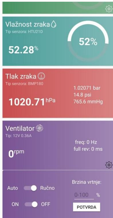
Slika 5.5: Mobilna aplikacija, ručni način - ventilator ugašen
