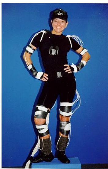
Slika 3.6 Primjer mocap odijela sa magnetskim senzorima
