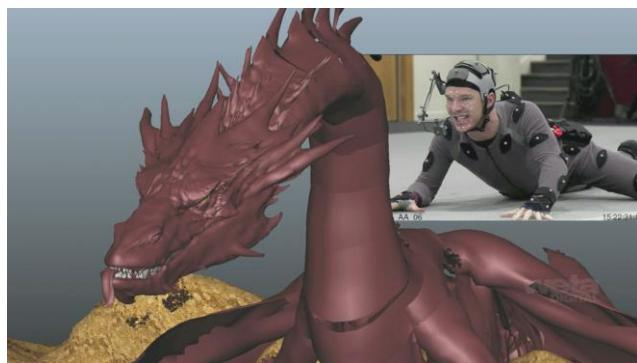
Slika 3.4 Mocap odijelo sa optičkim senzorima
