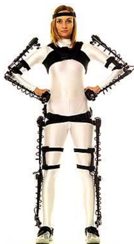
Slika 3.7 Primjer mocap odijela sa mehaničkim sensorima
