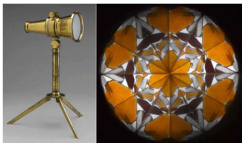
Slika 2.4 Kaleidoskop (lijevo) i prikaz funkcionalnosti uređaja (desno)
