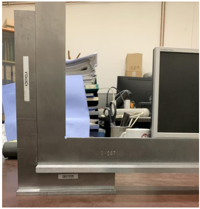
Slika 6.28. Kutnik - kontrola unutarnjeg kuta pomoću kontrolnog kutnika [10]
