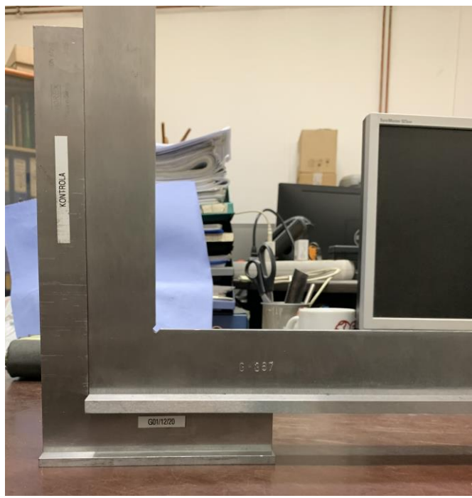
Slika 6.28. Kutnik - kontrola unutarnjeg kuta pomoću kontrolnog kutnika [10]
