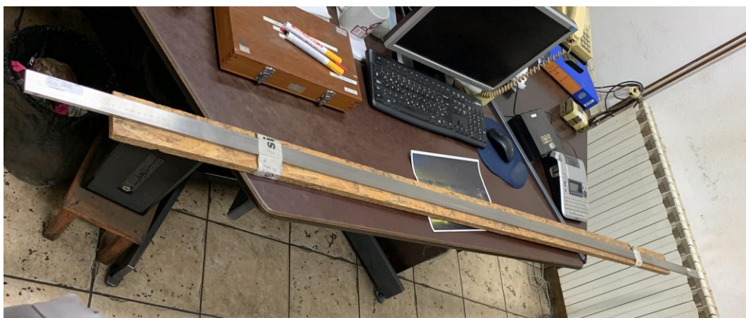
Slika 6.29. Mjerna letva za kontrolu čeličnih metara i ravnala [10]
