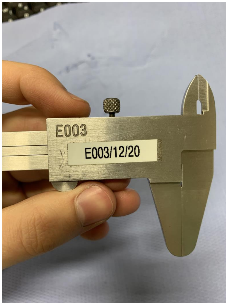
Slika 6.24. Pomično mjerilo – kontrolna markica (oznaka) [10]
