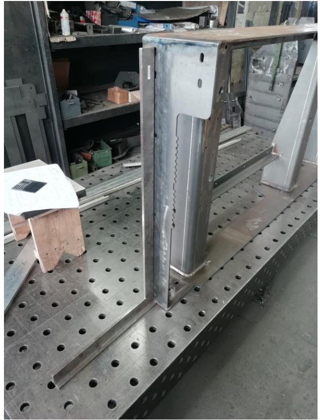
Slika 6.14. Kontrola kutnosti pomoću metalnog kutnika [10]
