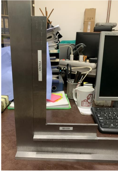
Slika 6.27. Kutnik - kontrola vanjskog kuta pomoću kontrolnog kutnika [10]
