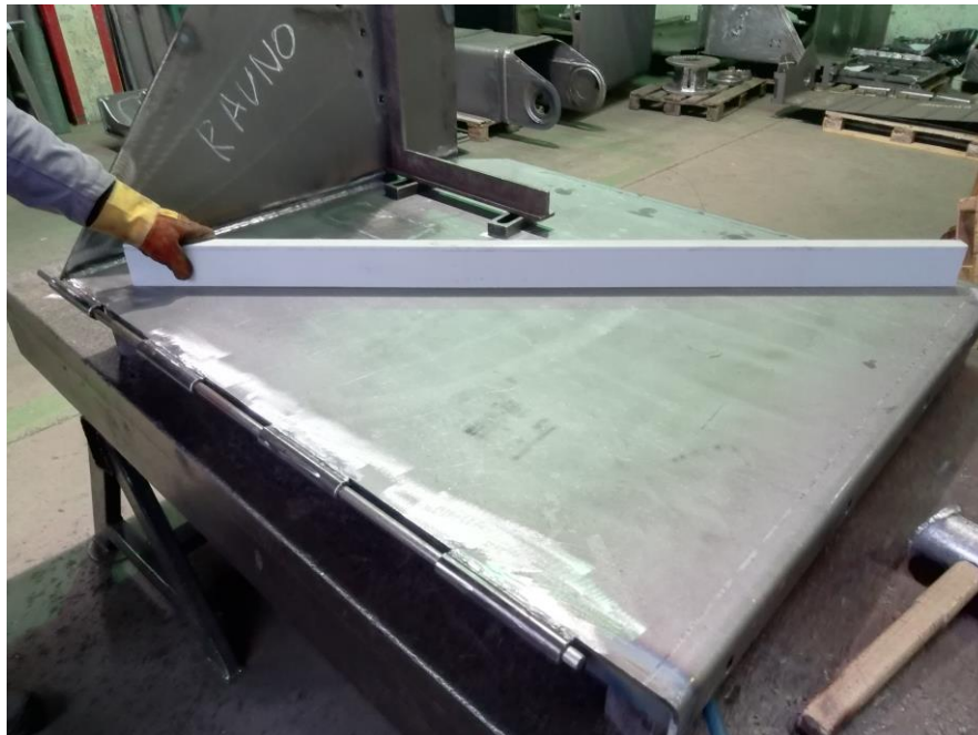
Slika 6.15. Kontrola ravnosti metalnim ravnalom (libelom) [10]
