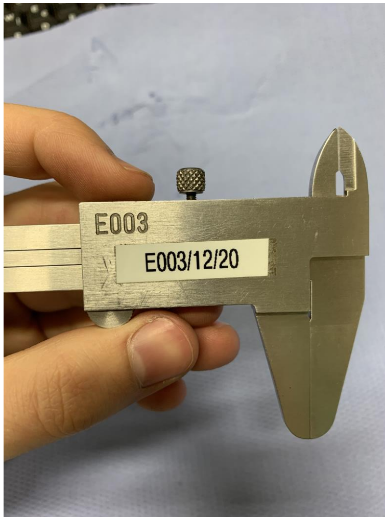
Slika 6.24. Pomično mjerilo – kontrolna markica (oznaka) [10]
