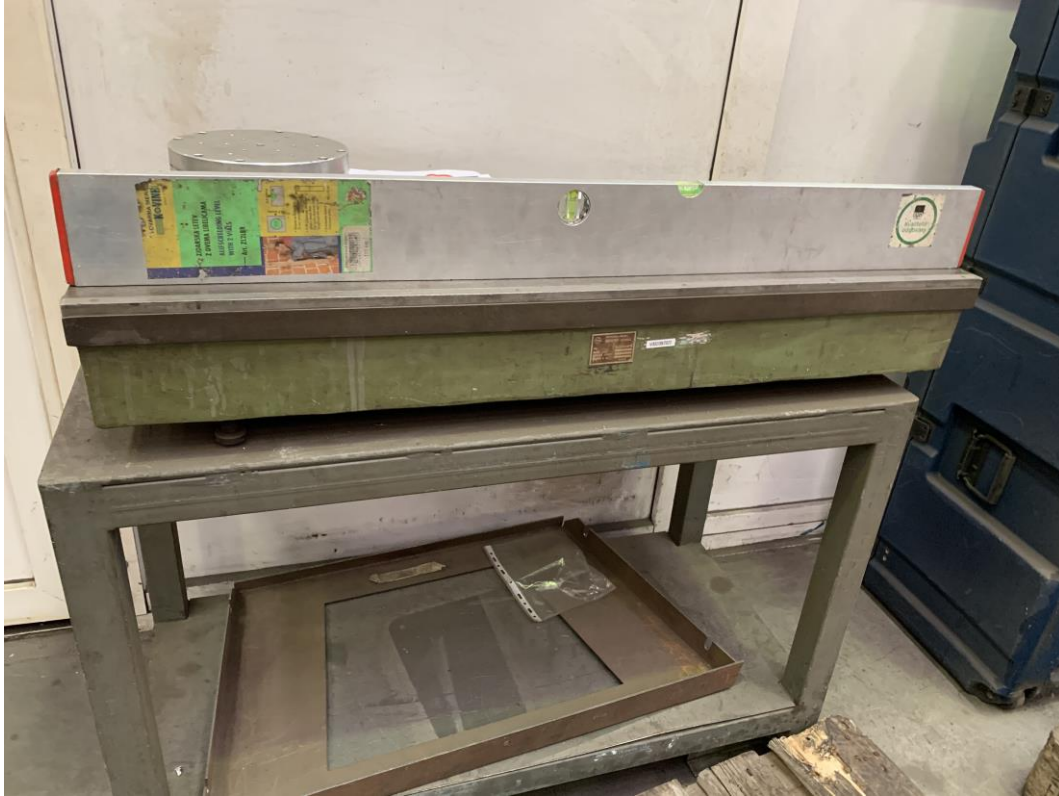
Slika 6.31. Kontrola ravnosti libele na mjernom stolu [10]
