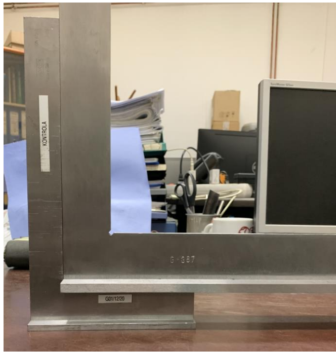
Slika 6.28. Kutnik - kontrola unutarnjeg kuta pomoću kontrolnog kutnika [10]
