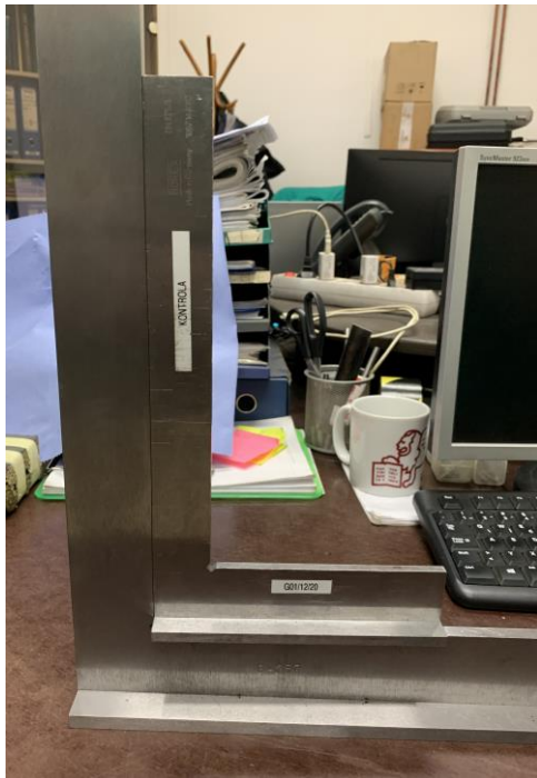
Slika 6.27. Kutnik - kontrola vanjskog kuta pomoću kontrolnog kutnika [10]
