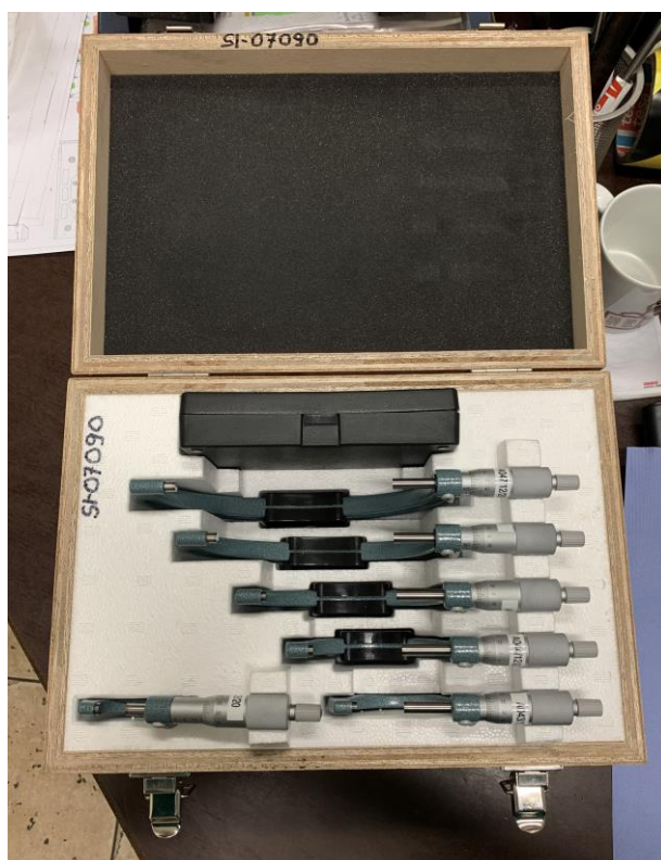
Slika 6.25. Mikrometri različitih mjernih područja [10]
