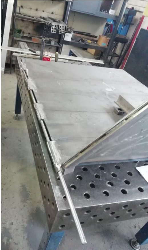
Slika 6.13. Kontrola koncentričnosti metalnom kontrolnom šipkom [10]
