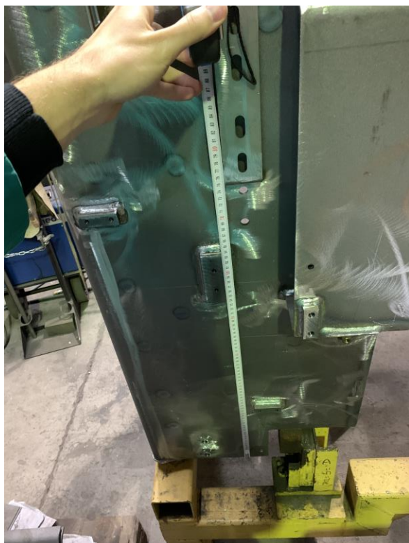
Slika 6.8. kontrola pozicije 56 pomoću čeličnog metra [10]
