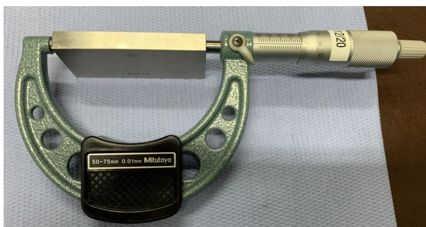
Slika 6.26. Mikrometar – provjera sa etalonom duljine 70 [mm] [10]
