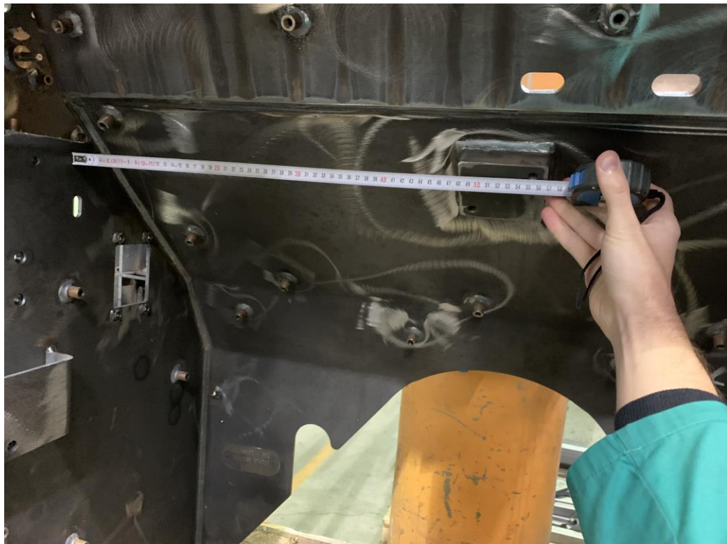
Slika 6.6. Kontrola pozicije 8 pomoću čeličnog metra - „PUMPENKASTEN“ [10]
