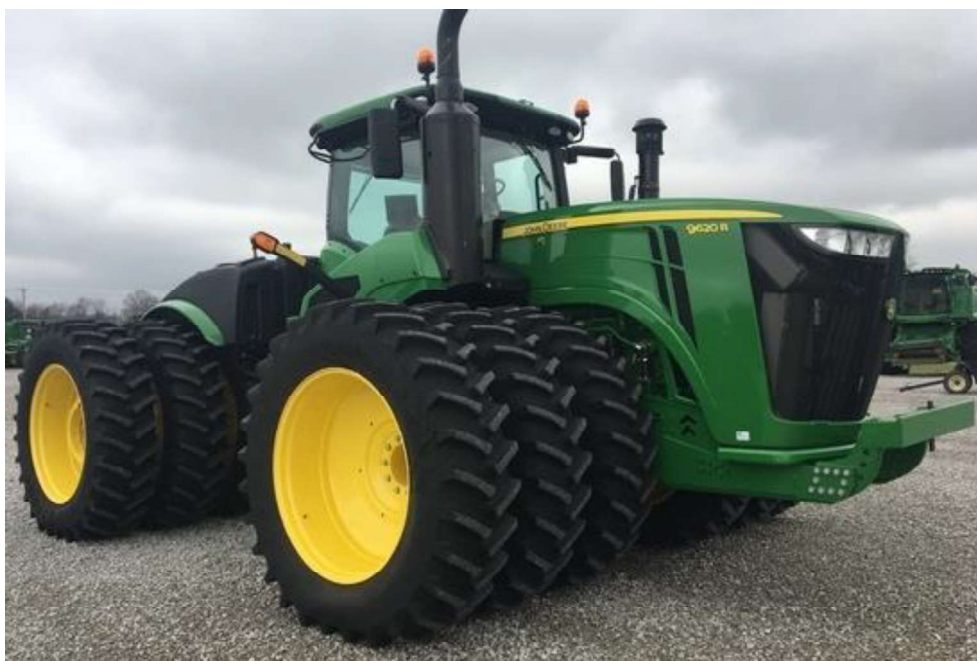
Slika 7: Prikaz John Deere 9620R traktora sa 12 kotača promjera 2054 mm i širine 520 mm [12]
